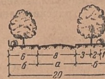
Фиг. 4. Решение на булевард, широк 20 м (съгласно „Техническите условия за проектиране градски пътища“)
